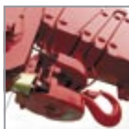
Sistema automatico anti-intasamento del gancio
